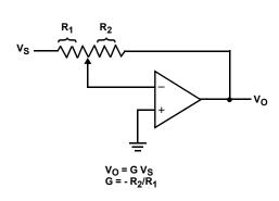
FIGURE 21. INVERTING AMPLIFIER
