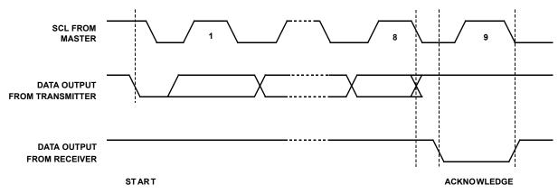
FIGURE 4. ACKNOWLEDGE RESPONSE FROM RECEIVER
