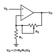
FIGURE 15. NONINVERTING AMPLIFIER
