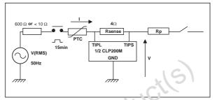
**Fig. 20 :** Power contact test  $\Im_{i}W^{it}$  10 $\Omega$  series).
